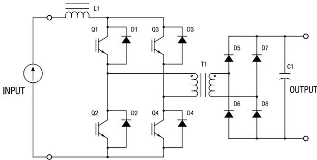
所有MagnaDC程控直流电源均采用基于高频IGBT的电流馈电式拓扑结构电力运行。与传统电压馈电式拓扑结构相比,该拓扑结构添加了一个额外功率保护极,加强了控制和系统防护,从而确保即使出现故障,电源也能实现自我防护。由于该拓扑结构的自我保护特性,从而消除了电流尖峰快速上升和磁芯饱和的可能性。
