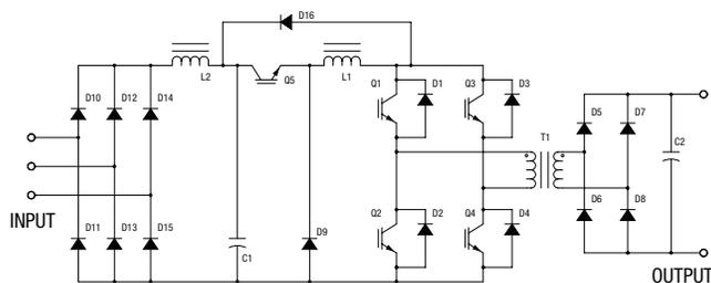
图3.整流器、斩波器和电流馈电式转换器
